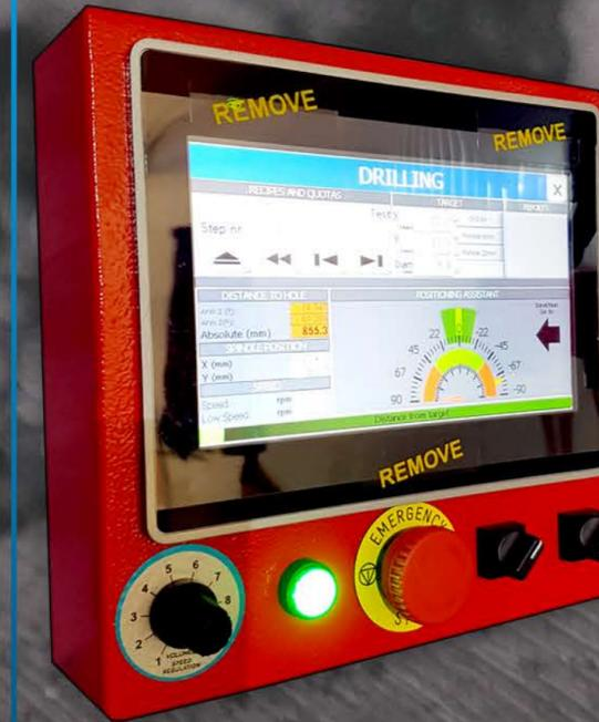
IL NUOVO SISTEMA DI CONTROLLO VAPS (VOLUMEC® ASSISTED POSITIONING SYSTEM) CON INTERFACCIA OPERATORE TOUCH-SCREEN, FACILE ED INTUITIVA, È POSSIBILE ESEGUIRE OPERAZIONI DI FORATURA E MASCHIATURA, ALLE QUOTE PRESTABILITE, SENZA PIÙ IL BISOGNO DELLA TRACCIATURA MANUALE COME NEI TRAPANI TRADIZIONALI.
