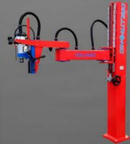
TUTTI I MODELLI DRILLTRONIC POSSONO ESSERE EQUIPAGGIATI CON COLONNA DI SOLLEVAMENTO PREDISPOSTA AL FISSAGGIO A PAVIMENTO.
