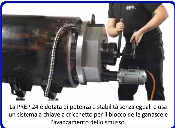
La PREP 24 è dotata di potenza e stabilità senza eguali e usa un sistema a chiave a cricchetto per il blocco delle ganasce e l'avanzamento dello smusso.
