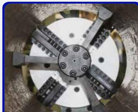
Le innovative e ampie ganasce di serraggio offrono un bloccaggio a 6 punti da 3 ganasce, fornendo una forza di serraggio superiore per smussi senza vibrazioni.
