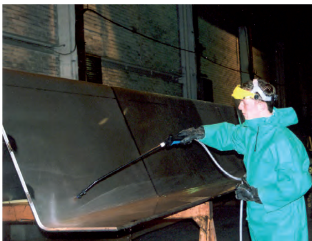
Passivazione di quello che sarà parte integrante della paratia di una chimichiera in acciaio inossidabile duplex
