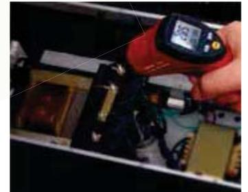
Per mezzo di un puntatore laser si identifica con estrema facilità il centro dell'area da misurare, rapporto di misura:
