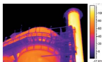
Verifica refrattario in acciaieria
