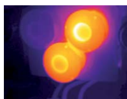
Termografia pannello: Si evidenzia la distribuzione termica sulla parte, dove vi è un delta di temperatura di 6°C. Linea L01.
