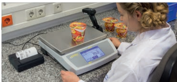
Controllo a campione di un preconfezionato con valore medio di tara, vale a dire che il peso relativamente costante di imballaggio è impostato come valore fisso.
