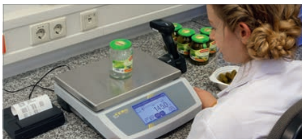
Controllo a campione di un preconfezionato con peso di imballaggio oscillante, come i recipienti in vetro, vale a dire che la tara viene impostata individualmente per ogni campione.
